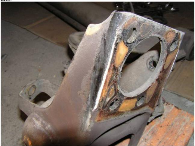
Con il flessibile con disco sottile 'mangiamo' la saldatura AL DI SOTTO DELLA PIASTRA!!! Ricordo che la piastra non dovrà essere toccata. Una volta mangiato il supporto da tutti i lati (dovrete andare in profondità nel metallo, le saldature che fanno entrano molto in profondità) Nella foto sembra che ho toccato la piastra, assottigliandola, ma non è così, è la foto rimasta male.
