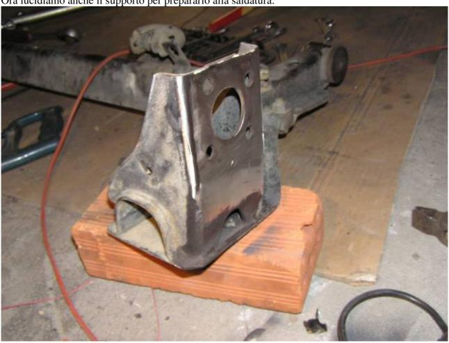
Fissiamo come meglio possiamo la piastra ricavata dal ponte dell'astra sul supporto del ponte del corsa/tigra:
