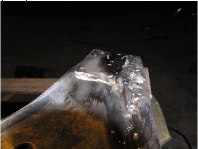
Se riuscite, dall'interno del supporto dove abbiamo saldato la staffa, riempiamo con una saldatura i vecchi fori dove si avvitava il mozzo con in tamburo
