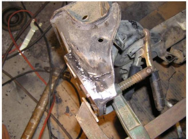
Come notate, nella parte alta (nella foto in basso a dx) del supporto ho riportato del materiale, questo serve per non indebolire la struttura originale, perché dopo dovremmo mangiare parte della parete interna per permettere l'inserimento del dado che andrà a stringere il mozzo al ponte.
