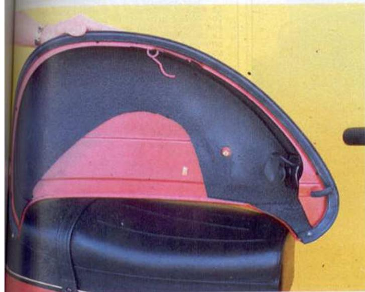
*L'interno delle fiancate è rivestito con materiale fonoassorbente per diminuire rumorosità e risonanze. La ruota di scorta è offerta in optional e ricoperta da una mezzaluna in plastica dove non arrivano le fiancate. Nelle pieghe più audaci si consuma anche questa terza ruota. Nello spazio all'interno della ruota si trovano l'apparecchiatura della accensione elettronica ed il vano per la batteria prevista per la versione con avviamento elettrico.*
